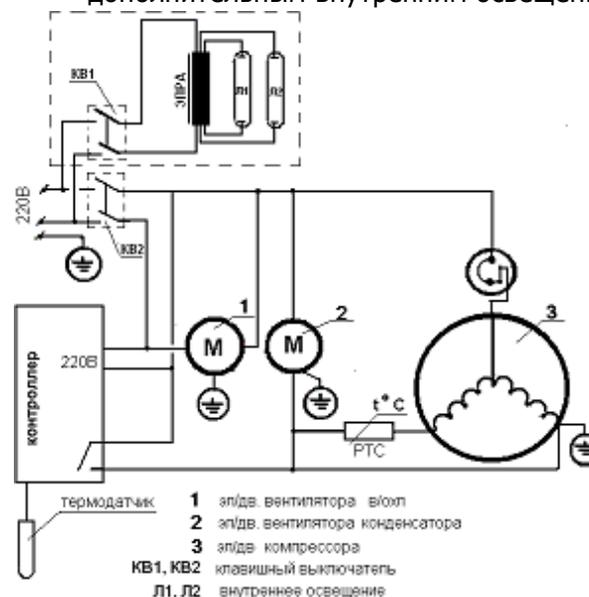
17.2 Электрическая схема стола ВТ.
